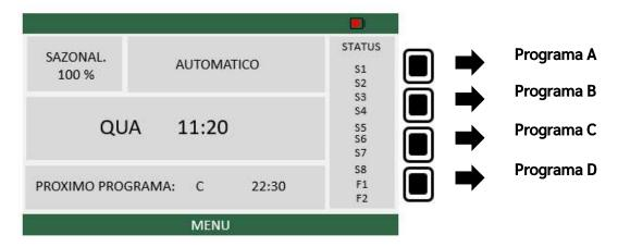
IMPORTANTE: Ao final do ciclo, o controlador permanece no modo AUTOMÁTICO. Para executar um programa manual e ao final ele permanecer em manual, a chamada do programa deve ser pelo caminho OPERAÇÂO→MANUAL→INICIAR PROG.
